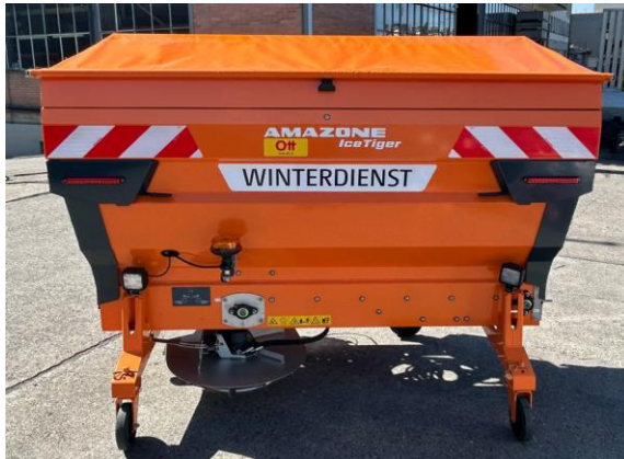
Winterdienststreuer AMAZONE IceTiger Easy: Behältervolumen 1'300 l (1'000 l Grundvolumen + 300 l Aufsatz), Nutzlast 2'950 kg, hydraulischer Streuscheibenantrieb, hydraulisch angetriebener Band- boden, Antrieb über Traktorhydrau-lik, mechanische Einleitsystemver- stellung, Terminalpaket EasySet, Elektronikpaket Easy, Abdeck- schwenkplane, LED-Beleuchtung für die Strassenfahrt, Abstellvorrichtung, Schmutzfänger und Schmutzgummi, Streuscheiben (2-8 m), LED-Arbeits- beleuchtung weiss und rot, LED- Behälterinnenbeleuchtung, Roll- vorrichtung steckbar, Signalkabel 7 pol.
