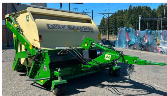
Mäher gezogen AMAZONE GH-S Drive 1800: Mit Deichsel und Behälterhochentleerung, 1.80 m Arbeitsbreite, 3'000 l Behälterinhalt, Gelenkwelle, Beleuchtung, Wegfahrsperre und Sicherungskette, Flügelmesser lang H77 geschliffen (99 Paar) in Kombination mit Vertikutiermesser 3 mm (99 Stück), Luftführungshaube (Baujahr 2022, Ausstellungsmaschine, ungebraucht)
