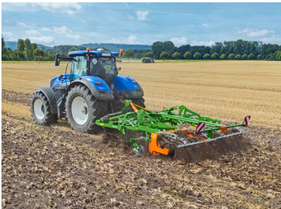
AMAZONE Doppel-Federringwalze DFW 580 im Einsatz mit Anbaugrubber Cenio 4000-2 Super in 4 m Arbeitsbreite.
