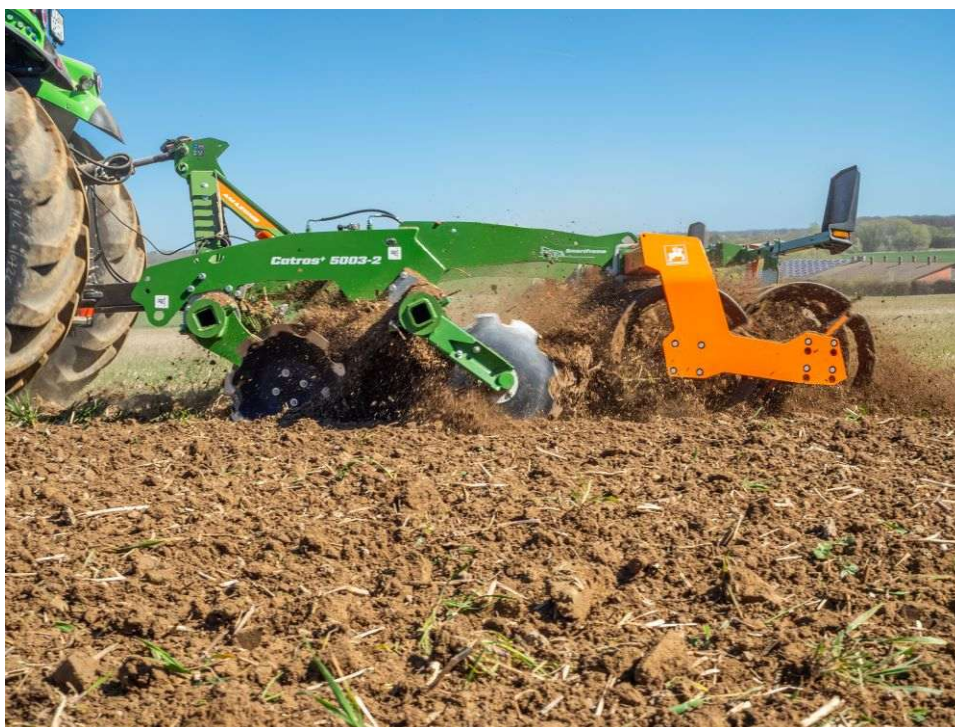
AMAZONE Doppel-Federringwalze DFW 580 im Einsatz mit Anbau-Kompaktscheibenegge Catros+ 5003-2 in 5 m Arbeitsbreite.
