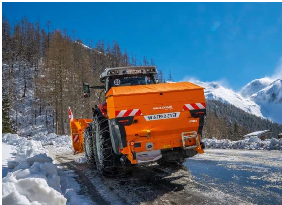
Épandeur hivernal IceTiger Inox avec volume de trémie de 1'000 l à 1'900 l
