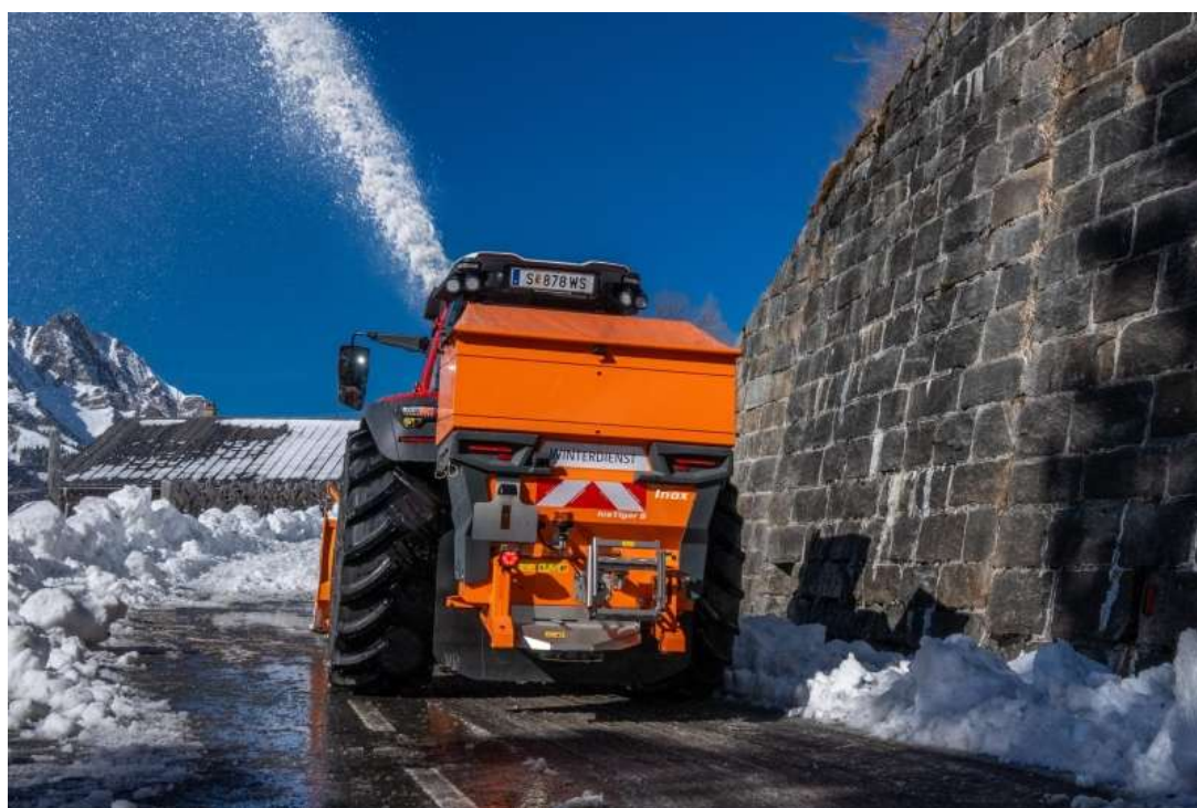
Épandeur hivernal IceTiger S Inox avec volume de trémie de 380 l à 920 l
