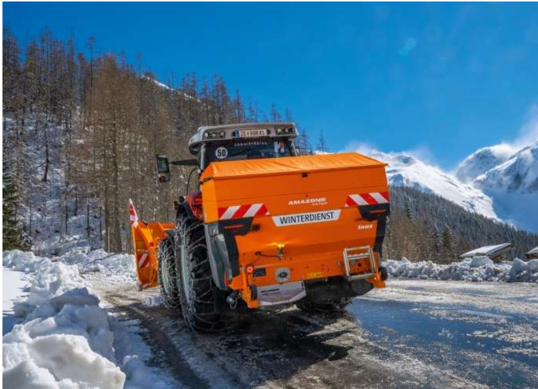
Winterdienststreuer IceTiger Inox mit Behältervolumen von 1'000 l bis 1'900 l
