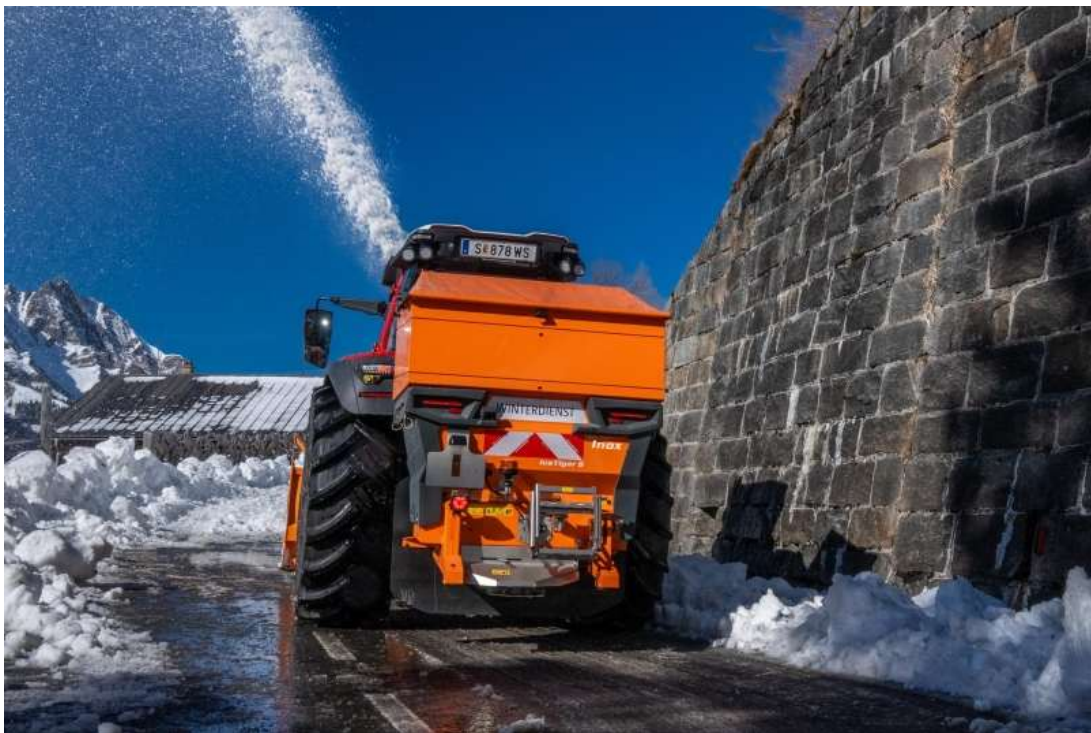
Winterdienststreuer IceTiger S Inox mit Behältervolumen von 380 l bis 920 l
