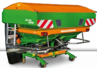
ZA-TS: Capacité de trémie de 1.400 l à 5.000 l largeur de travail 15 m jusqu'à 54 m
