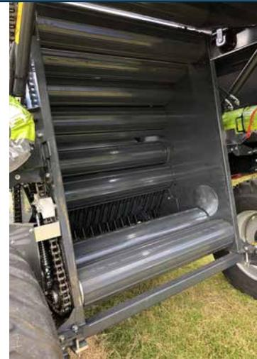
Presskammer mit zwei Bodenwalzen.
