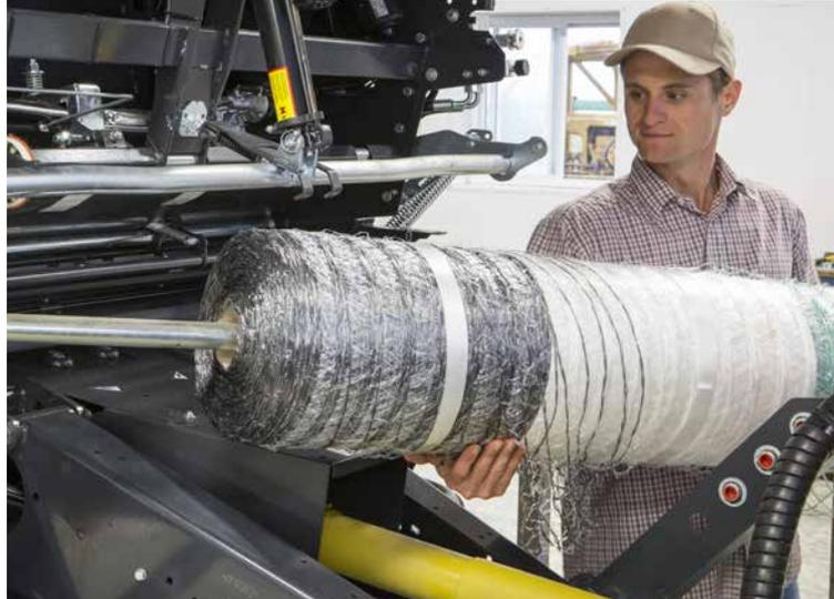
Die niedrige Ladehöhe und das leichte Einlegen der Netzzrollen bedeuten minimale Standzeit zum Netzwechsel und mehr produktive Zeit zum pressen.
