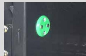
Sensor zur Feuchtigkeitsmessung.
