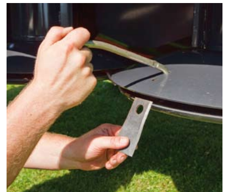
Klingenschnellwechsel – Werkzeug herunterdrücken und die Klingen wechseln.
