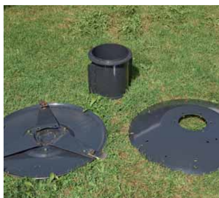
Die Mähtrummeln bestehen aus mehreren Teilen. Das hat den Vorteil, dass im Falle eines Schadens nur die defekten Teile getauscht werden müssen. Im Falle einer Reparatur spart dies Kosten.
