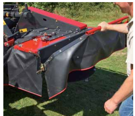
Seitliche Schutzabdeckungen sind einfach für den Straßentransport klappbar.
