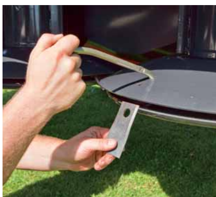
Klingenschnellwechsel – Werkzeug herunterdrücken und die Klinsen wechseln.
